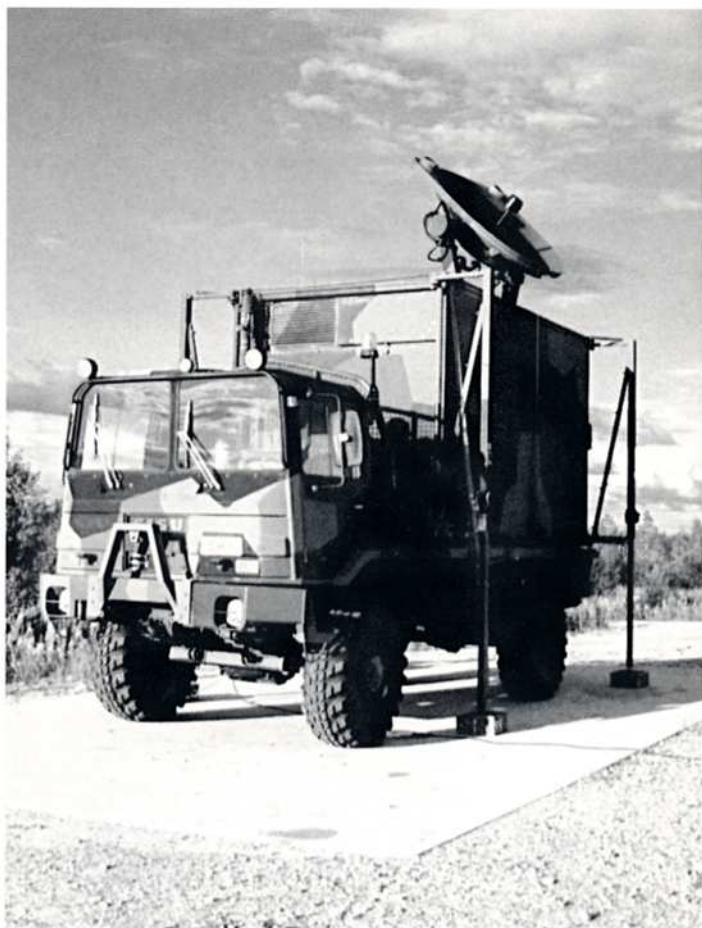
Kauas ammuttaessa tarvitaan tarkka sääsanoma. Kuvassa automaattinen säänluotauskalusto.
