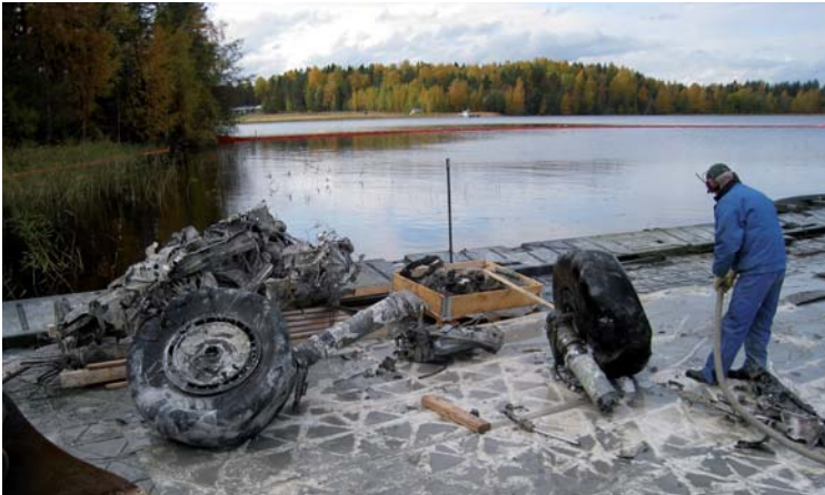
Koneen etupyörät nostettuna lautalle. Pyörien löytymisen perusteella saatiin selkeämpi kuva koneen putoamisasennosta sekä mahdollisten pommien sijainnista.
