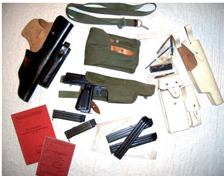
PM-63 konepistoolin varustevalikoimaa; erilaisia kuljetuskoteloita, kunnossapitovälineitä, 1- ja 2-tason teknisiä ohjekirjoja, lippaita ja lipastaskuja.
