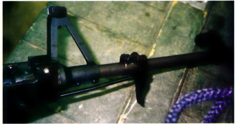
Aseen liippsinmekanismi kiinnittyy piippuun ja välittää työntövarren avulla liikkeen laukaisukoneistoon, joka sijaitsee perinteisellä paikalla aseeseen runkossa. Valmet M82-mallin tähtäimet kiinnittyvät molemmat piippuun. Kuvassa näkyy takatähtäin.
