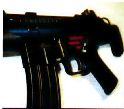
Rynnäkkökiväärin vasemmalla puolella, lippaan kiinnityskohdalla, näkyy alhaalta ylös lukien lippaan salpa, luistin vapautin ja ase- kanto- kahva.
