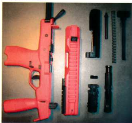
Käsittelykonepistooli on laajempaa käyttöhuoltoa (ns. kausihuolto) varten purettuna.
