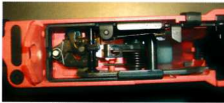
Konepistoolin laukaisukoneiston rakenne on selkeä, mutta varsin poikkeuksellinen teknisesti.
